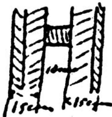
Avec cela le mur était pourvu de cavités. À travers ces cavités passait un canal d'approvisionnement en air frais en tôle, qui commençait dans un linteau de fenêtre et débouchait derrière les radiateurs dans ladite salle blanche au 3<sup>e</sup> étage. Il est donc
